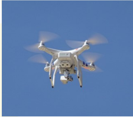
Figura 1: un drone a quattro rotori. Il carico è visibile nella parte inferiore del drone.
