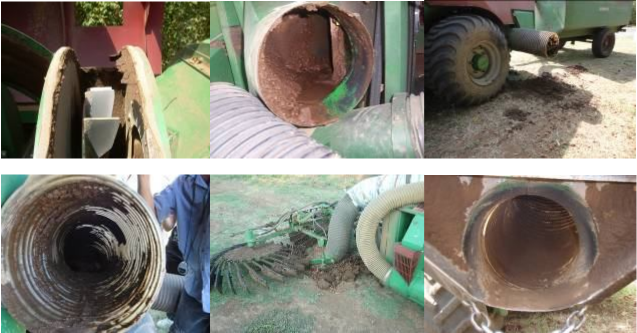
Fig. 13: accumulo di fango nella macchina Cimina 380
