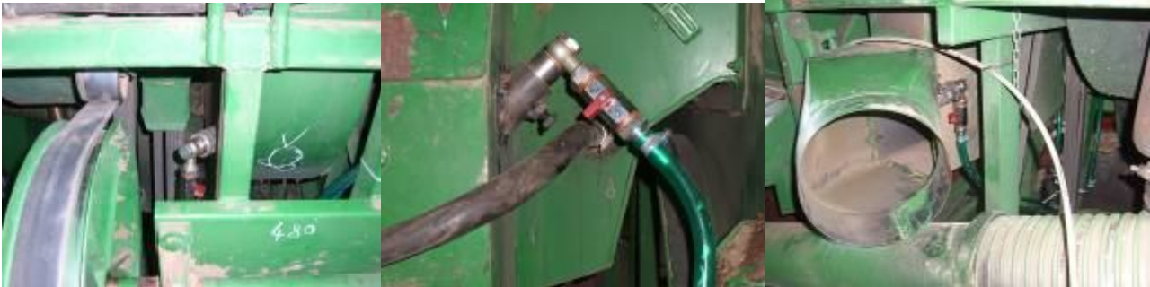
Fig. 12: rubinetti in prossimità degli ugelli
